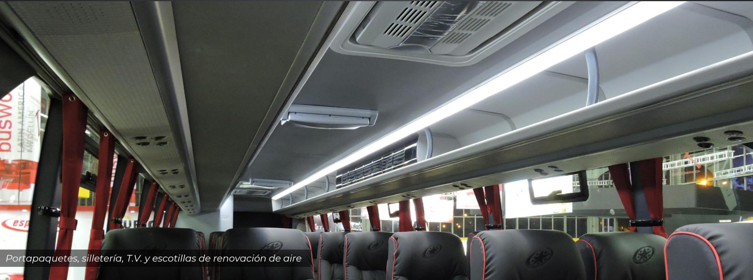
*Portapaquetes, silletería, T.V. y escotillas de renovación de aire*
